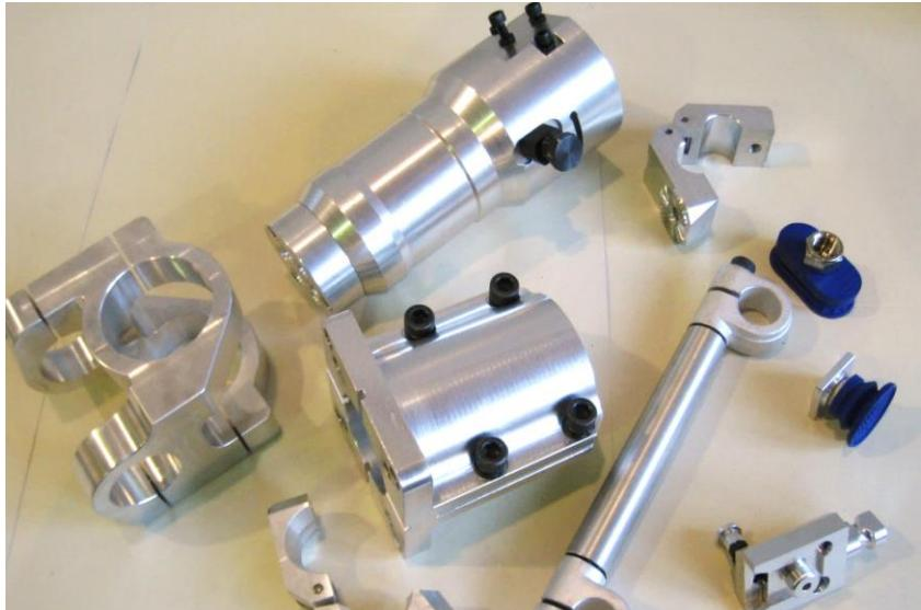
**EOAT** – krajnji efektori robota su elementi ruke robota koji omogućavaju razne izvedbe na robotizovanim sistemima u svim granama industrije.
